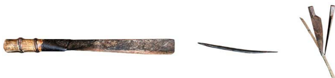
从左到右：篾刀（用来破竹和破篾）、篾针（用来编织）、圆刀（划出等宽的篾片）。
