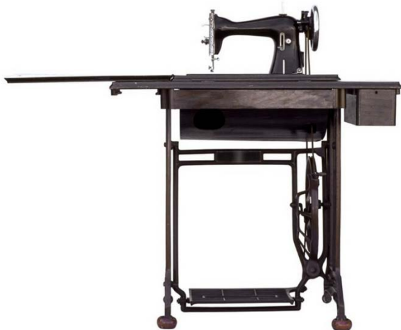
老式缝纫机，用脚踏踏板来产生动力。
